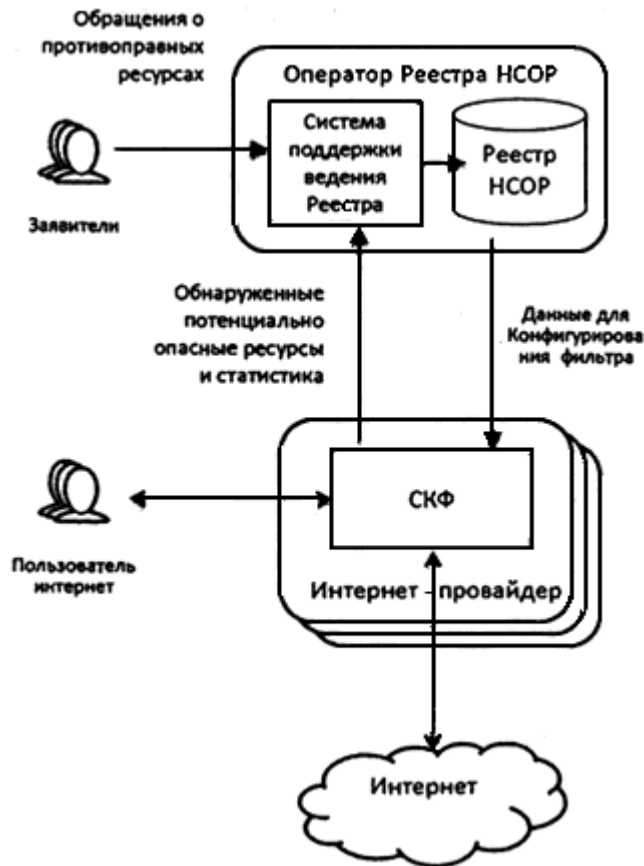
Рис. 6. Принцип контроля доступа через Реестр NSOP
