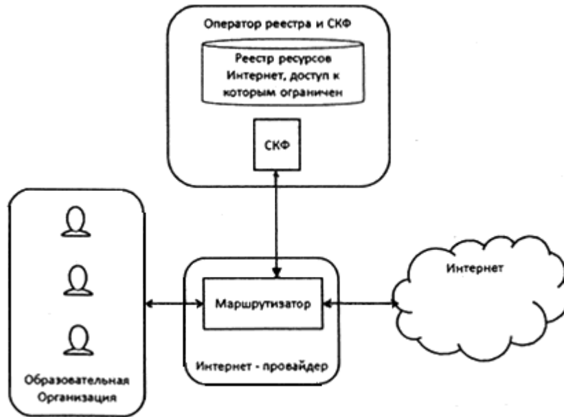
Рис.5. Схема работы контент-фильтрации при едином решении
